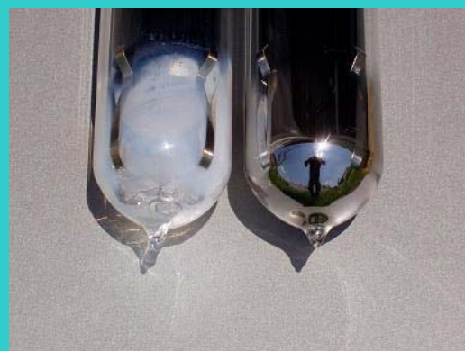
Δεξιός σωλήνας: Καλός Αριστερός Σωλήνας: Χαλασμένος Τα πόδια από το getter είναι ορατά μέσα στους σωλήνες
