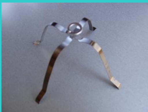
Το getter από βάριο βρίσκεται στο κάτω μέρος του εξωτερικού σωλήνα
